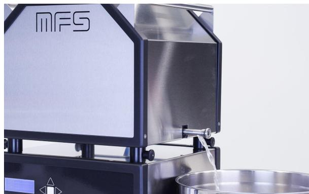
Der MFS ist zur besseren Handhabung innerhalb der Produktionsanlagen in zwei separate Einheiten unterteilt. Die untere Einheit enthält die Stromversorgung und die elektronische Steuereinheit. Der obere Teil enthält den Wassertank und die Ultraschallvernebler.
